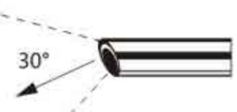
A0012 30° 内窥镜 Endoscope Φ4×302mm
